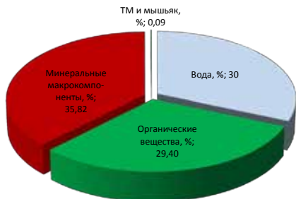
► Рис.1. Компонентный состав осадков сточных вод, подсушенных и выдержанных в естественных условиях в течение нескольких лет
